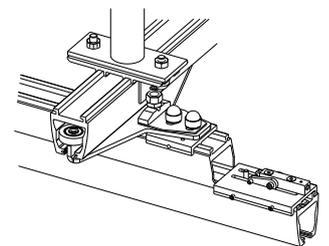
Les dispositifs de verrouillage des profilés en M et en L sont livrés avec une petite plaque qui doit impérativement être installée.
