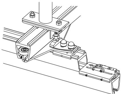
Le dispositif de positionnement des rails profilés en S est en partie monté dans le dispositif standard. Il est donc important de placer un dispositif de fixation standard devant le rail de raccord.
