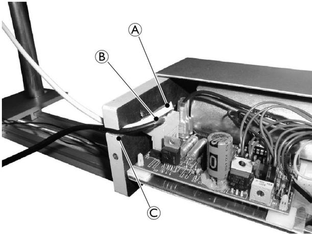
Avant le raccordement du bouton de commande et du bloc d'alimentation, il est nécessaire de démonter les capots du bloc moteur. Pour ce faire, il suffit de desserrer les deux vis qui maintiennent chaque capot, puis de tirer horizontalement sur les capots pour les placer sur le côté.
