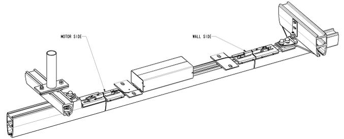
Le compartiment moteur et les dispositifs de verrouillage doivent être placés tels que fournis à la livraison, pour garantir le bon fonctionnement et la sécurité du système. Les dispositifs de fixation des suspensions peuvent être placés librement tant qu'ils sont conformes à la construction du système. Reportez-vous au schéma de mesures ci-dessous.
