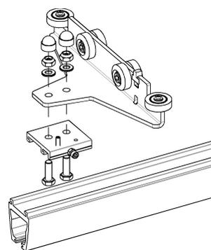
Que les deux chariots de traverse soient orientés à l'opposé l'un de l'autre ou dans la même direction, il est essentiel que les deux supports de traverse rapides soient dans la même direction, sans quoi des problèmes risquent de se produire lors du montage du rail.
