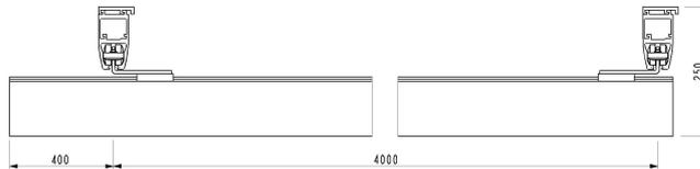
Une fois les rails parallèles montés et les chariots de traverse et butées de fin de course correctement positionnés et fixés, installez les supports de traverse rapides au-dessous du chariot de traverse, comme indiqué sur l'illustration.
