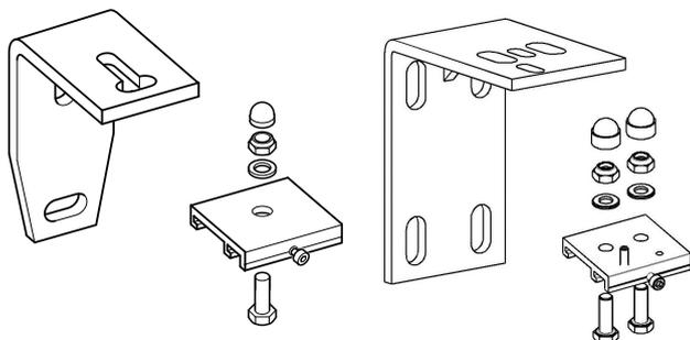
Mesurez toujours la distance entre les deux murs précisément, à la bonne hauteur et au bon emplacement du système. Le support mural peut être ajusté à +/- 6 mm. Si un ajustement supérieur est requis, utilisez une plaque de 6 mm entre le support et le mur.
