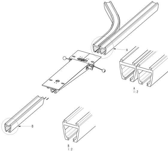
L'aiguillage de voie ne peut être utilisé qu'en association avec une installation au plafond et des rails profilés en S. L'aiguillage de voie est conçu pour un support de plafond standard.
